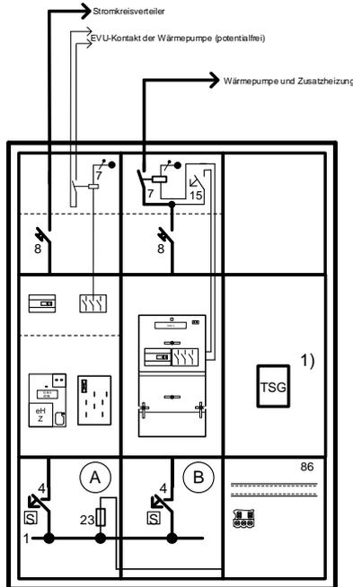
(A) Wärmepumpe, Steuerung über potentialfreiem Kontakt mit Koppelrelais und Regelung der Anlage
